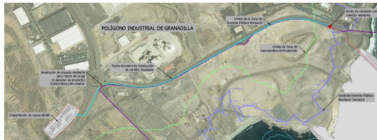
Imagen 6. Trazado esquemático del tramo terrestre de la conducción de desagüe ejecutado. Fuente: CIVILPORT Ingenieros, S.L.U.
