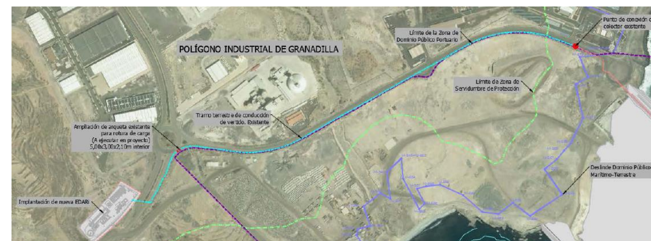
Figura 12. Trazado existente del tramo terrestre de la conducción de desagüe. Fuente: CIVILPORT Ingenieros, S.L.U.
