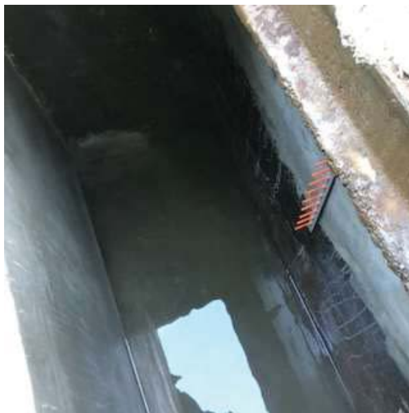
Figura 2-9. Detalle de la regleta de clavos instalada bajo el vertedero de la tanquilla para realizar las pruebas de aforo
